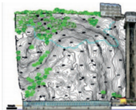
Postelaborazione per curve di livello da rilievo fotogrammetrico
